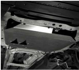
Tấm Bảo Vệ Gầm Động Cơ. Được thiết kế bằng hợp kim nhôm cao cấp, giúp bảo vệ động cơ khỏi những tác động ngoại cảnh.
