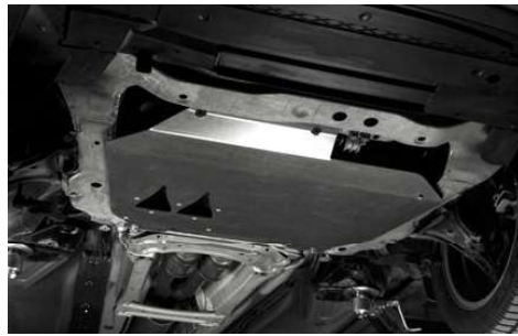
Tấm Bảo Vệ Gầm Động Cơ. Được thiết kế bằng hợp kim nhôm cao cấp, giúp bảo vệ động cơ khỏi những tác động ngoại cảnh.
