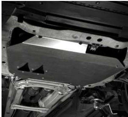
Tấm Bảo Vệ Gầm Động Cơ. Được thiết kế bằng hộp kim nhôm cao cấp, giúp bảo vệ động cơ khỏi những tác động ngoại cảnh.
