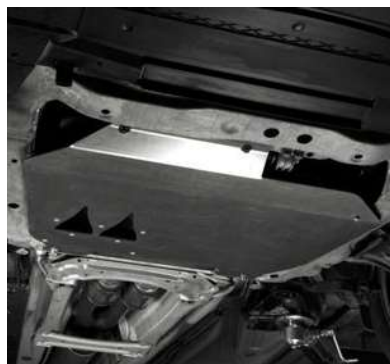
Tấm Bảo Vệ Gầm Động Cơ. Được thiết kế bằng hộp kim nhôm cao cấp, giúp bảo vệ động cơ khỏi những tác động ngoại cảnh.
