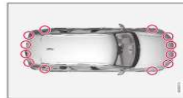
Vị trí của cảm biến đỗ xe 138 .
