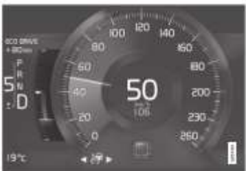
Đồng hồ Eco trong màn hình người lái 8 inch. Đồng hồ Eco báo mức tiết kiệm nhiên liệu khi lái xe:
